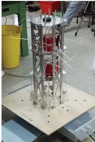
頂層 65cm 載重 8.4 kg，45 cm 載重 14.4kg，25 cm 載重 7.2kg，震動強度 800gal
