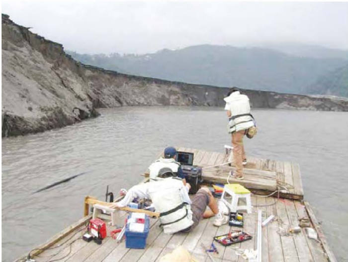
▲圖五：計畫研究者實地在霧社水庫測試監測紊流下沉積河床的聲波顯影策略。
